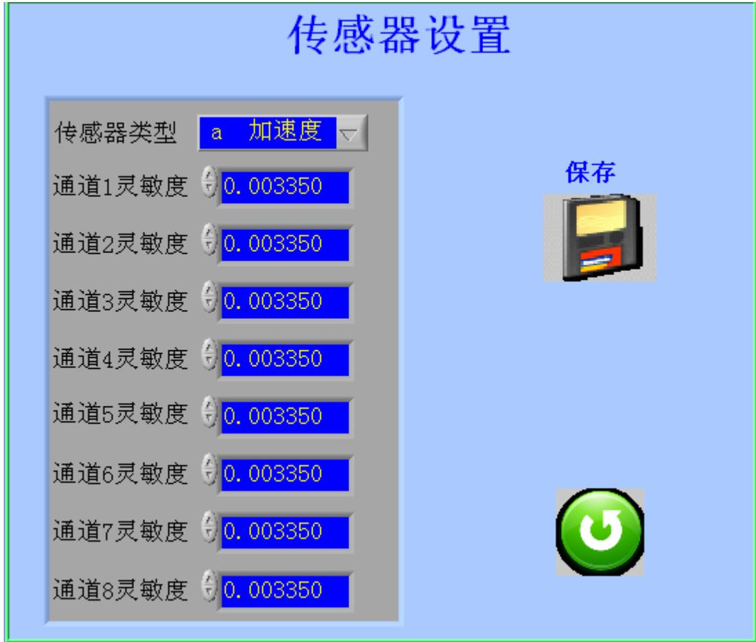
2、在传感器类型中可以选择加速度、速度、位移三种类型，如下图：
