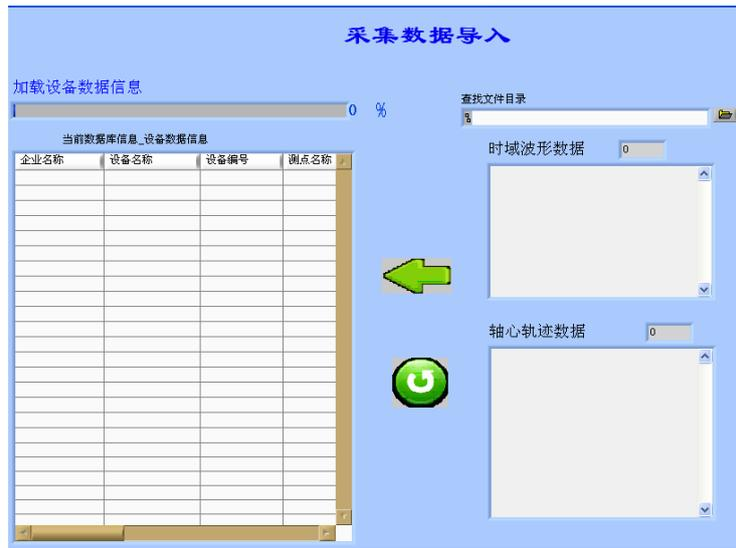
弹出如下对话框，在电脑中找到从采集器复制到电脑上的“data”文件夹并打开，选中某一条数据点击“打开”则所有数据读入到“时域波形数据”和“轴心轨迹数据”两个列表。
