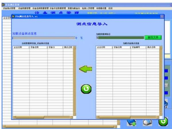
要加载测点信息先点击“查找文件”按钮，弹出如下对话框，在电脑中找到从采集器复制到电脑上的“cedian”文件，点击“打开”则文件中数据已添加到下面列表中。
